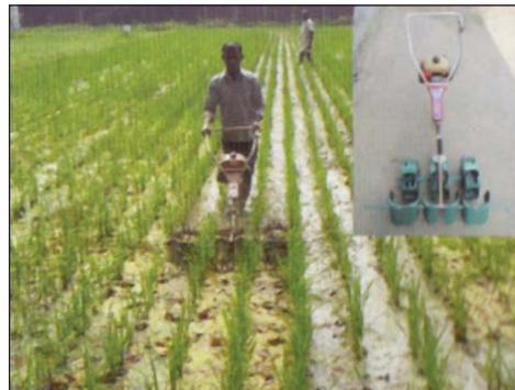
চিত্র ৭০। ব্রি পাওয়ার উইডার।
